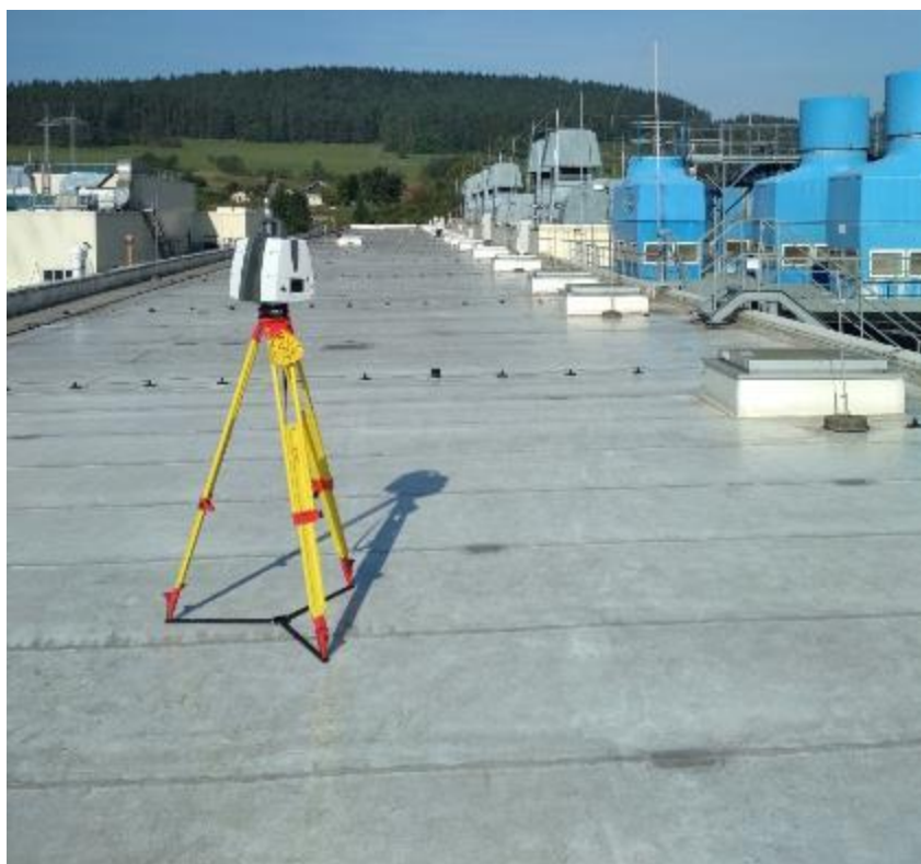
Obr. 1 Skenovacie zariadenie Leica P30 pri skenovaní strechy výrobnéj haly
