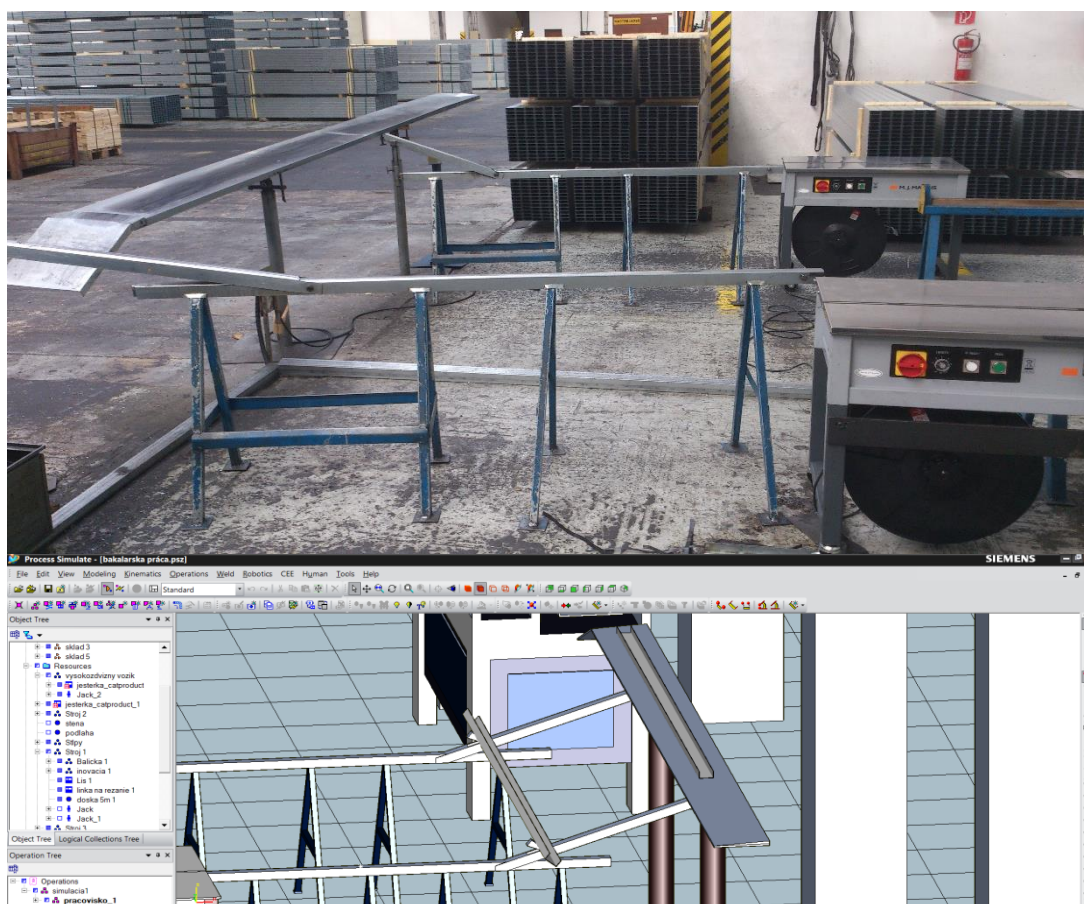
Obr. 6 Odoberací stôl v skutočnosti a po inovácii
